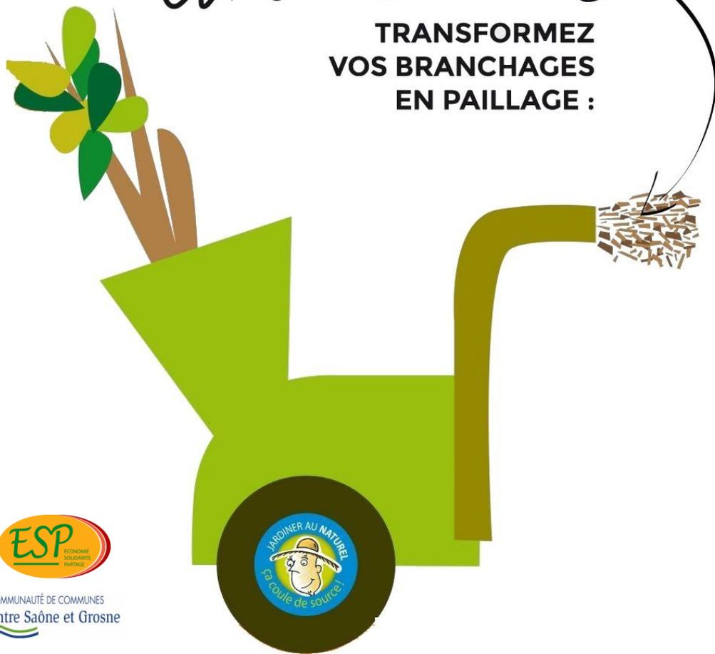
Le broyeur accepte un diamètre de branches jusqu'à 12cm, pour un rendement approximatif de 20 m<sup>3</sup> à l'heure (selon conditions d'accessibilité et rangement des branches élaguées).
